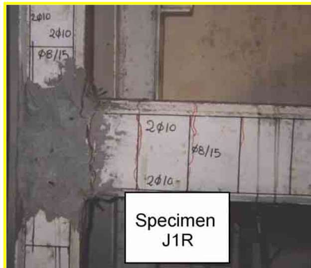
Επισκευή περιοχής κόμβου με ρητινένεσις σε δοκίμιο κόμβου δοκού – υποστύλωματος στο Εργαστήριο Ωπλισμένου Σκυροδέματος ΔΠΘ
