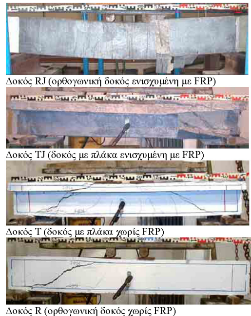
Αποτελέσματα διατμητικών δοκών ενισχυμένων με ανθρακούφασματα (Εργαστήριο Ωπλισμένου Σκυροδέματος ΔΠΘ)
