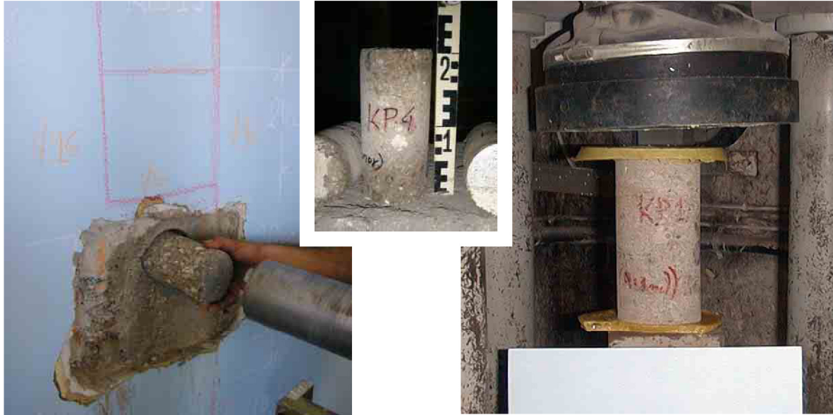
Πυρήνας (“καρότο”) από σκυροδέμα υφιστάμενου υποστυλώματος – Δοκιμή πυρήνα σε αξονική θλίψη μετά από “καπέλωμα” των επίπεδων επιφανειών του ώστε να είναι παράλληλες
