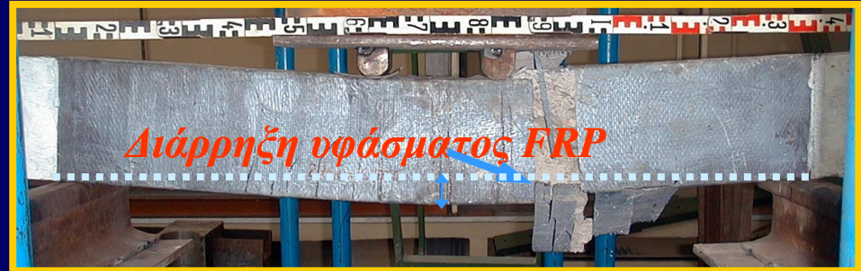
Δοκός RJ: Τα υφάσματα από FRP άλλαξαν ριζικά την συμπεριφορά σε καμπτική (πλάστιμη).
