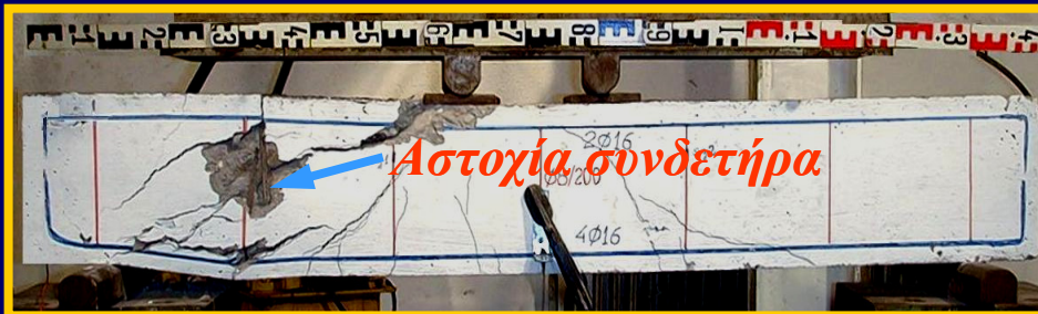
Δοκός RS: Τυπική διατμητική αστοχία δοκού με συνδετήρες.
