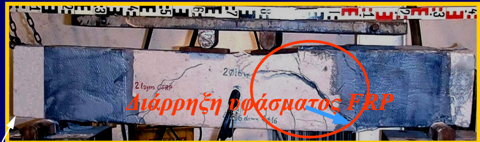
Δοκός RJe: Τα υφάσματα από FRP στα ακραία τμήματα περιόρισαν την ανάπτυξη ρηγματώσεων.
