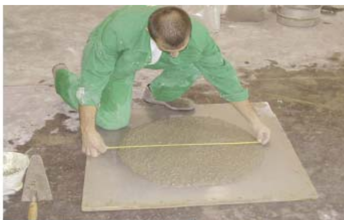
Σχήμα 2: Συσκευή μέτρησης του μέτρου εξαπλώσεως αυτοσυμπυκνούμενου σκυροδέματος.
