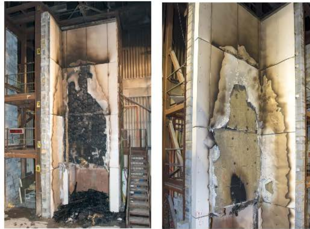
Αριστερά: εύφλεκτη μόνωση, δεξιά: μη εύφλεκτη μόνωση Δοκιμές 5 και 6 του Υπουργείου Κοινοτήτων και Τοπικής Αυτοδιοίκησης (DCLG).
